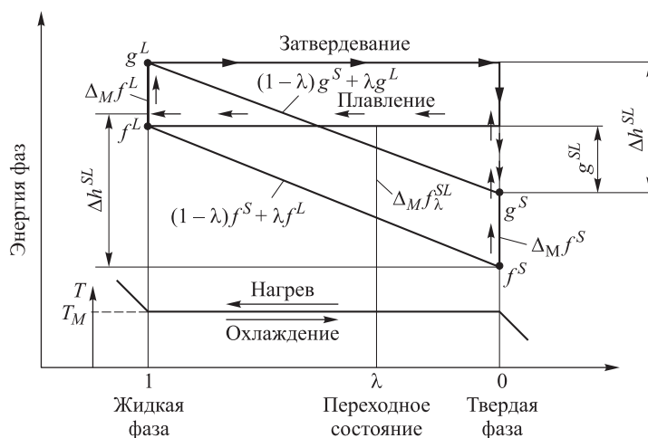
Рис. 1. Изменение потенциалов свободной энергии гетерогенной системы от долей жидкой и твердой фаз
