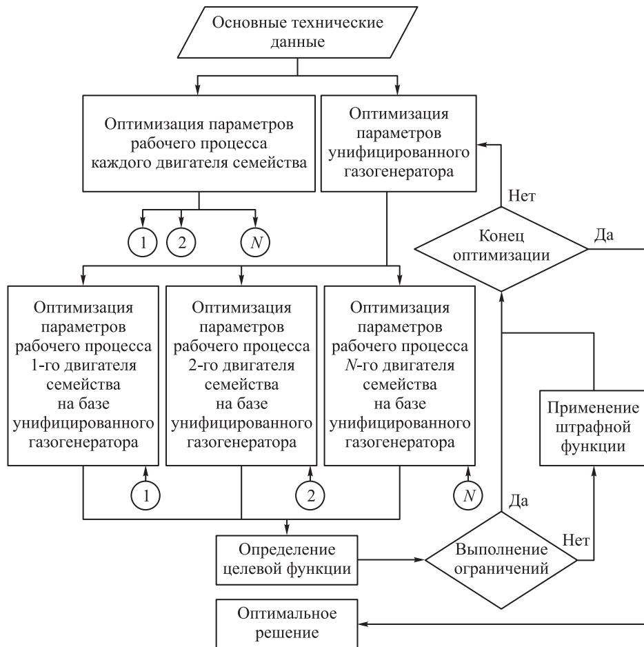
Рис. 3. Алгоритм метода выбора параметров рабочего процесса семейства ГТД на базе унифицированного газогенератора
