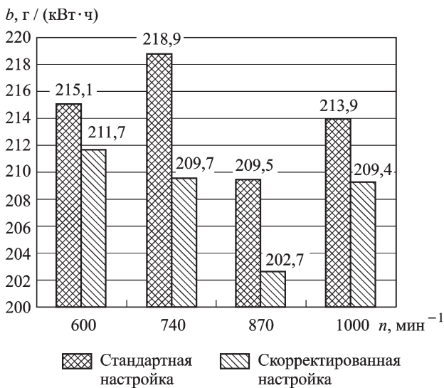
Рис. 3. Зависимость удельного эффективного расхода топлива от частоты вращения двигателя при различных настройках турбокомпрессора
