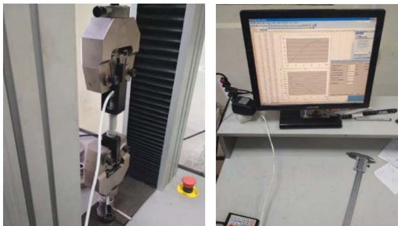
Рис. 5. Тарирование индуктивного преобразователя перемещения ISAB A41A-43P-5-P
