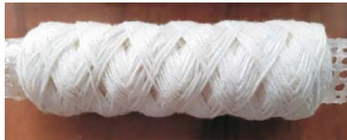
Рис. 5. Схема спиралевидной намотки
