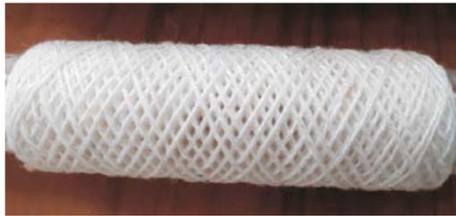
Рис. 4. Сотовая структура намотки нити
