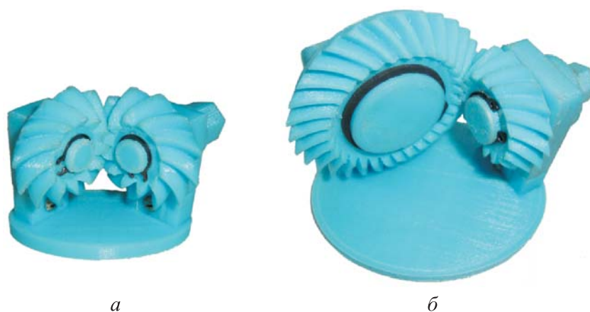
Рис. 4. Распечатанные на 3D-принтере физические модели конических передач с винтовым зубом, выполненные по вариантам № 1 (а) и 2 (б)
