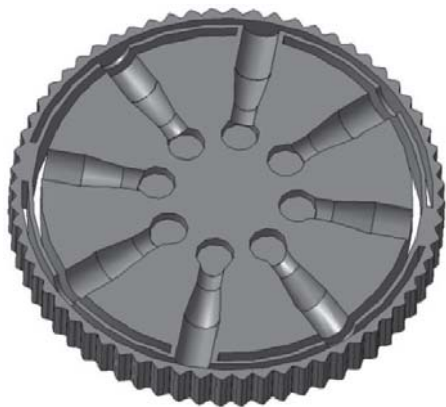
Рис. 1. Пружинный пакет (разрез)
