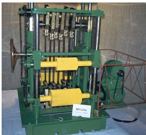
Рис. 1. Принципиальная схема (а) и опытный образец (б) многопильного станка “Шершень М2001” с круговым поступательным движением полосовых пильных полотен
