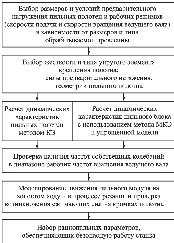
Рис. 10. Блок-схема методики выбора рациональных параметров многопильного станка
