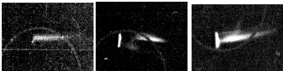
Рис. 4. Факел продуктов разрушения материала П5-2 в моменты времени T_a = 1,3; 5,7 и 17 с соответственно a, б, в
