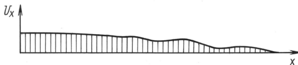
Рис. 3. Эпюра продольных перемещений по длине полусферы
