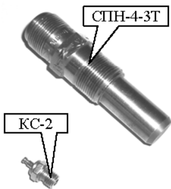
Рис. 6. Свечи электроискровой и калильной систем воспламенения топлива
