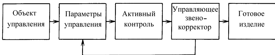
Рис. 2. Структурная схема процесса подналадки
