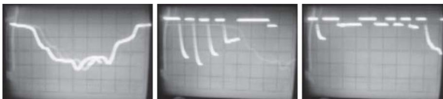
Рис. 5. Сигналы с контактов фотоэлементов, модулированные синусоидой с частотой 50 Гц
