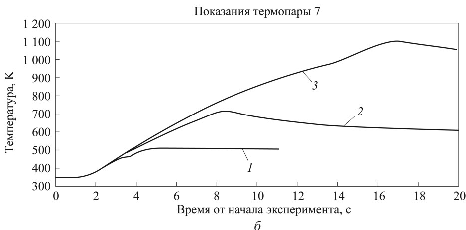
Рис. 6. Экспериментальные зависимости температуры внешней поверхности стенки КС:
