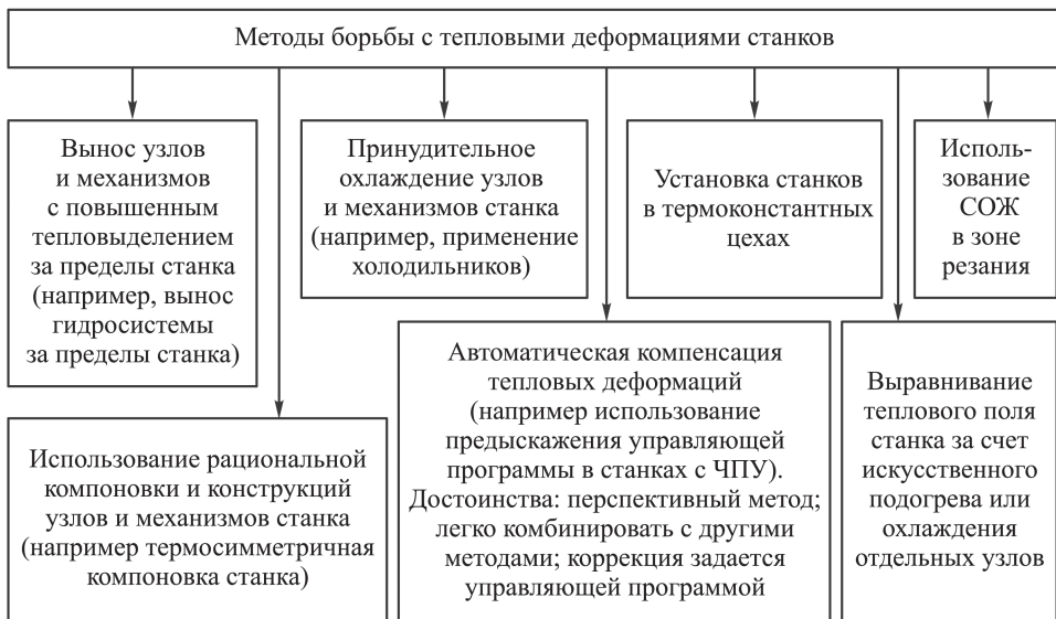
Рис. 1. Методы борьбы с тепловыми деформациями
