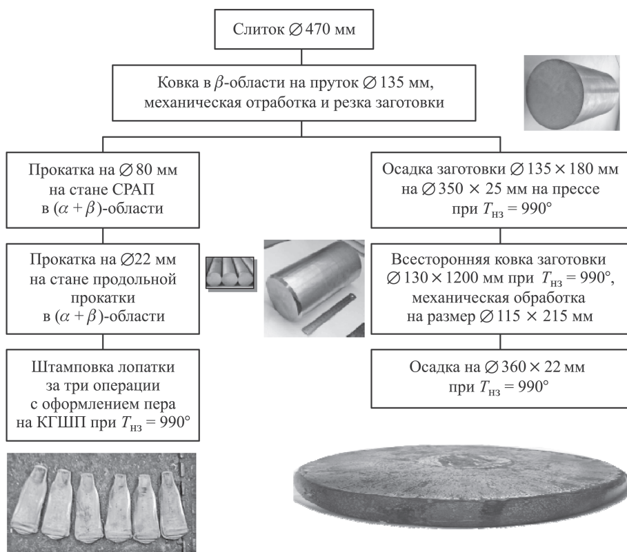
Рис. 1. Технология изготовления полуфабрикатов из сплава ВТ41 (температура полного полиморфного превращения T_{\text{пп}} = 1022 °С)
